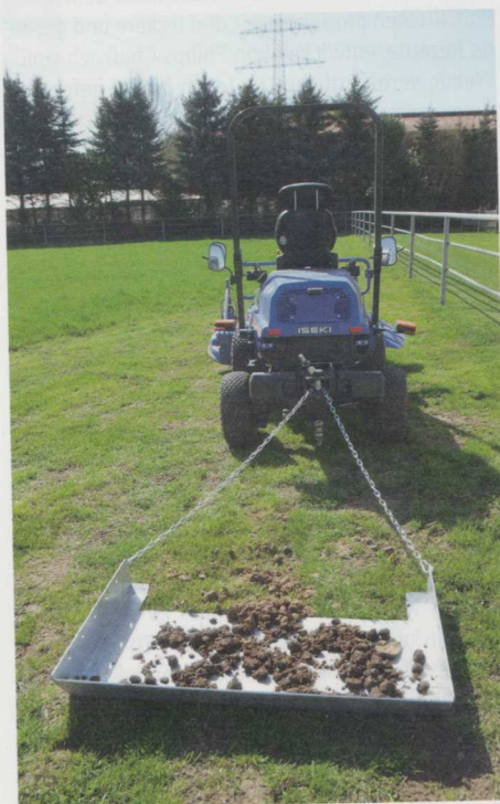
Der Sascotec-Paddockboy wird einfach an einen Traktor, Lader, Auto oder Quad gehängt, sodass der Pferdebesitzer über die Koppel fahren und auf dem Weg alle Äpfel problemlos einsammeln kann. Foto: Elke Jakobi
